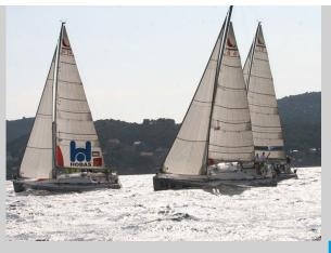
Speziell auf der ersten Kreuz müssen wir versuchen immer im freien Wind zu bleiben. Auf dem Bild links hat nur das erste Boot freien Wind. Das Boot mit der Segelnummer 6 befindet sich direkt im Abwindkegel des führenden Bootes. Boot 2 befindet sich zwar etwas in Luv des führenden Bootes bekommt aber ebenfalls noch die abgelenkte Luft ins Segel.
